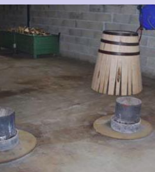
Après la mise en rose vient la chauffe (aussi appelé 'bousinage')- phase qui influence largement les caractéristiques de l'eau-de-vie
