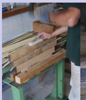
Fabrication des couvercles et des fonds – étanchéité obtenue grâce à l'insertion de feuilles de jonc entre les douelles
